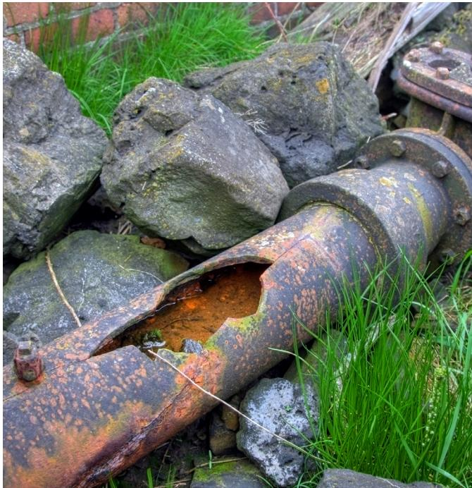
causé par des événements externes tels une intrusion accidentelle ou des conditions environnementales telles une invasion de racines, une dégradation, un gel ou un arc électrique.
